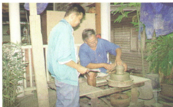
ภาพที่ 2-12 แสดงการใช้แป้นหมุนขึ้นรูปผลิตภัณฑ์
