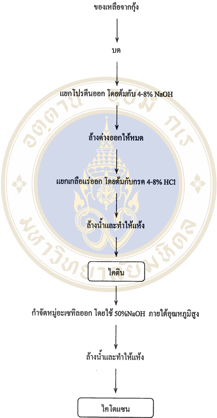
รูปที่ 2-6 ขั้นตอนการผลิตไคตินและไคโตแซนจากเปลือกกุ้งด้วยวิธีทางเคมี (20)
