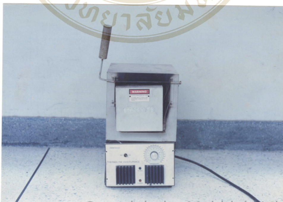
รูปภาพที่ ก.4 แสดงเตาเผาอับอากาศ อุณหภูมิสูง 1,200 \pm 5 องศาเซลเซียส
