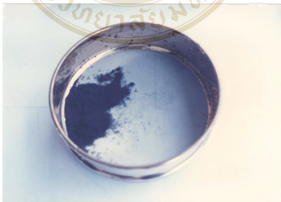
รูปภาพที่ ก.8 แสดงการร่อนด้วยตะแกรงร่อน ( sieve ) ขนาด 325 mesh
