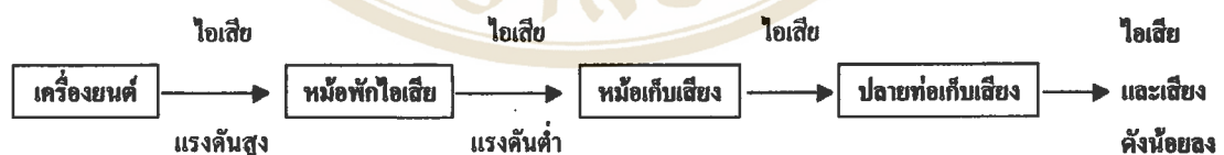
รูปที่ 5-3 แสดงกระบวนการในการลดระดับเสียงและควันดำจากเรือหางยาวเครื่องยนต์ดีเซล (20)
