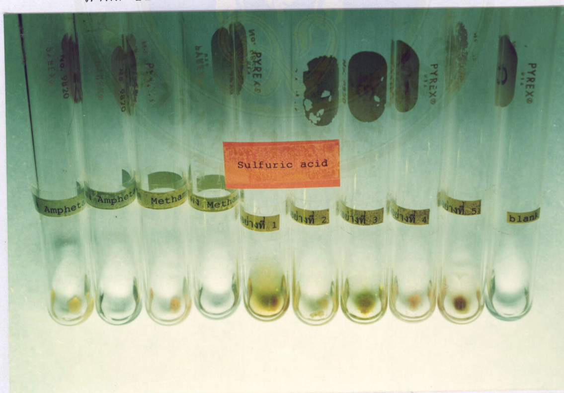
ภาพที่ 13 การเกิดปฏิกิริยาของสารกับ Sulfuric acid
