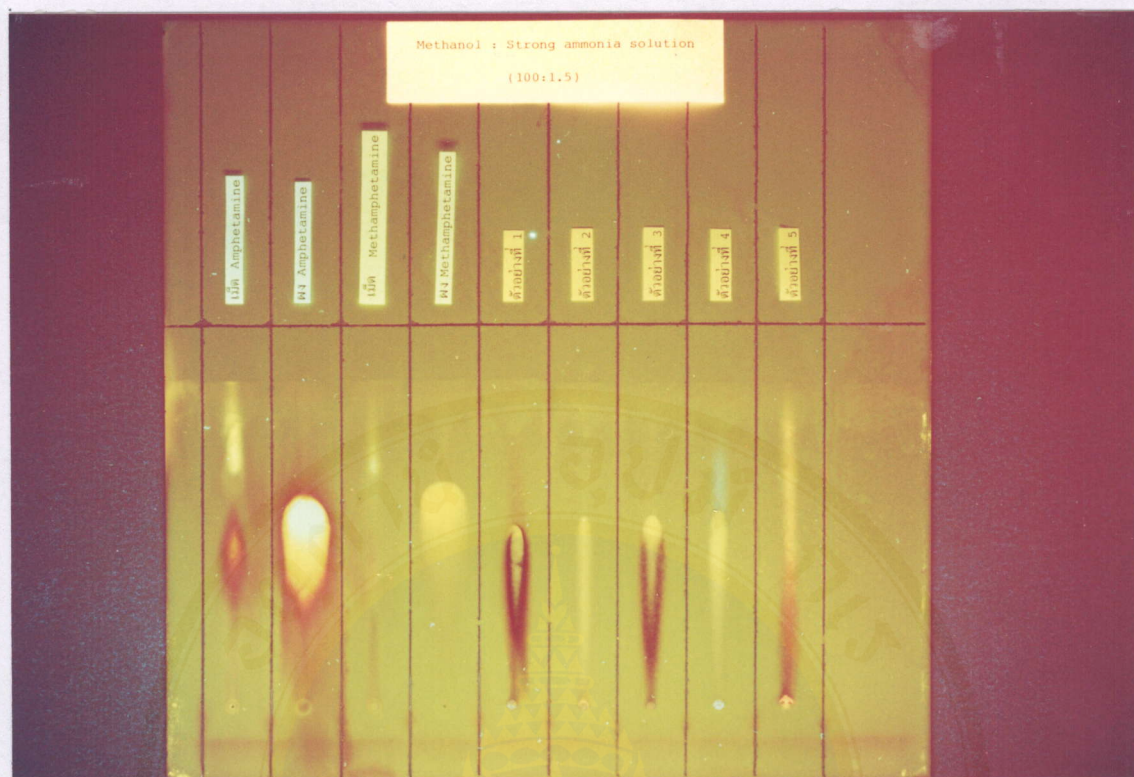
ภาพที่ 20 TLC Chromatogram ใน system ที่ 1 (ดูด้วย UV light)
