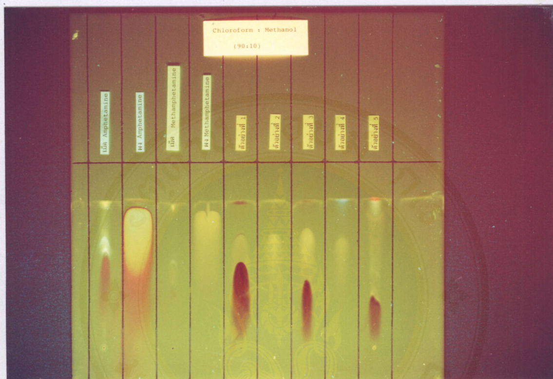
ภาพที่ 22 TLC Chromatogram ใน system ที่ 3 (ดูด้วย UV light)
