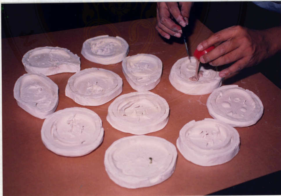
ภาพประกอบที่ 17 แสดงการหล่อแบบโพลีเอสเตอร์เรซิน
