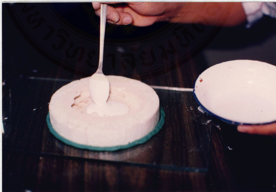
ภาพประกอบที่ 8 ใส่ปูนปลาสเตอร์ในแม่พิมพ์
