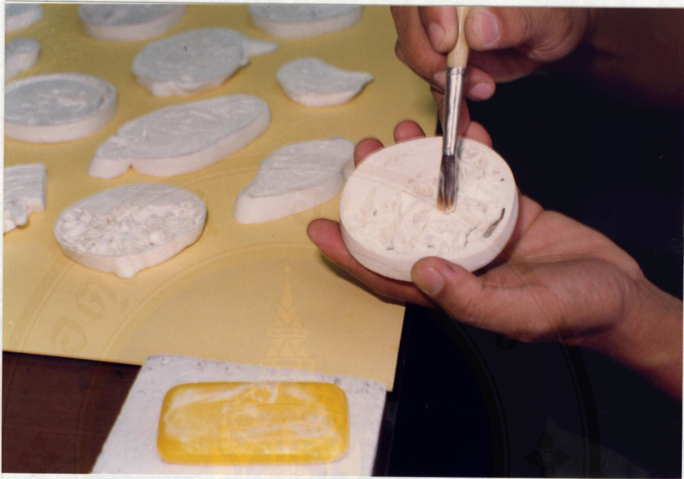
ภาพประกอบที่ 14 ทาน้ำสบู่เพื่อความสะดวกในการถอดแบบ
