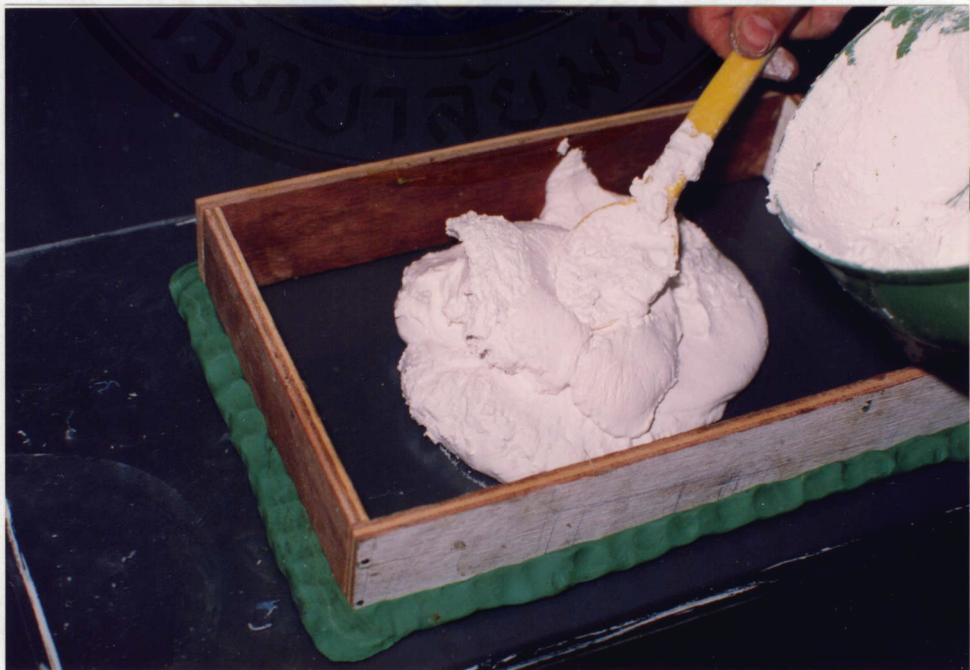
ภาพประกอบที่ 21 ใส่ปูนปลาสเตอร์ลงใน Block
