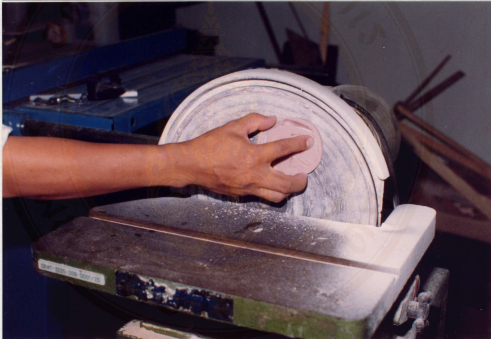
ภาพประกอบที่ 18 แสดงการปรับความหนาของชิ้นงานโพลีเอสเตอร์กับแท่นขัดไฟฟ้า
