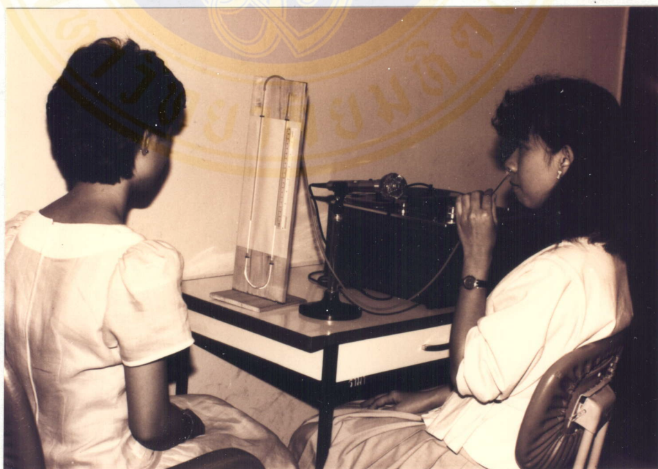
รูปที่ 2 การวัดค่าแรงดันลมในช่องจมูกด้วย U-tube water manometer
