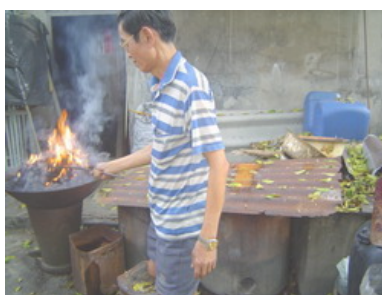
รูปที่ 4-16 แสดงการหลอมทอง ของ คุณ ชีรภัทร แซ่ไคว่
