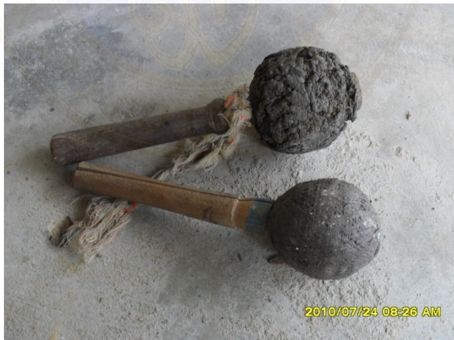
ภาพที่ ๓.๓๔ ไม้ตีกรือโตะที่ใช้ขยำพาราพันหัวไม้สำหรับตี
