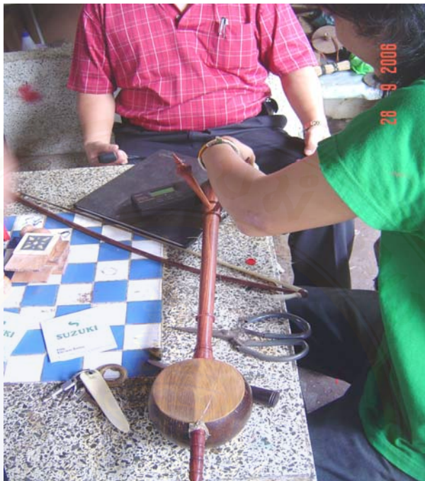
ภาพที่ ๖-๑๖ การใส่ลูกบิดและการใส่สายเอกและสายทุ้มสะล้อ บันทึกภาพโดย : กิจชัย ส่องเนตร ปีพุทธศักราช ๒๕๔๕
