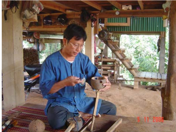
ภาพที่ ๖ – ๓๒ การเจาะช่องเสียบคันทวนและตบแต่งเสียง
