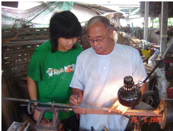
ภาพที่ ๖ – ๕ บุญรัตน์ ทิพย์รัตน์ ช่างทำสะล้อยกำลังวัดขนาดและสัดส่วนของไม้เตรียมกลึง คันทวนสะล้อยให้เรียบร้อย
