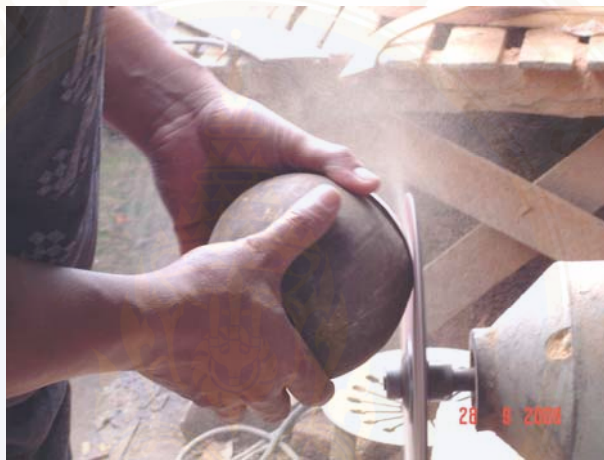
ภาพที่ ๖ – ๑๑ ขั้นตอนการขัดกะโหลกมะพร้าวสำหรับทำกล่องเสียงสะล้อ บันทึกภาพโดย : กิจชัย ส่องเนตร ปี พุทธศักราช ๒๕๔๕
