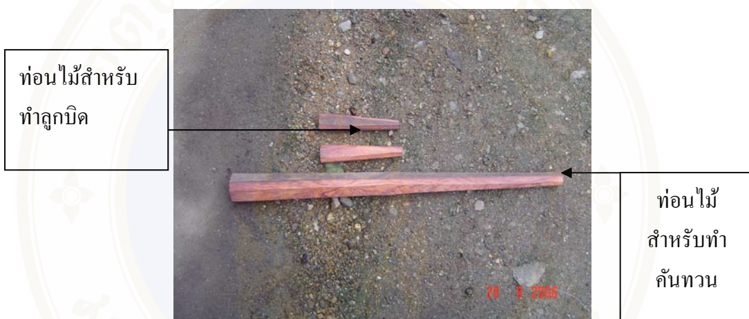
ภาพที่ ๖ - ๔ การเตรียมไม้ชิงชัน สำหรับทำคันทวนและลูกบิดสล้อของ ช่างบุญรัตน์ ทิพย์รัตน์ บันทึกภาพโดย : กิจชัย ส่องเนตร พุทธศักราช ๒๕๕๕
