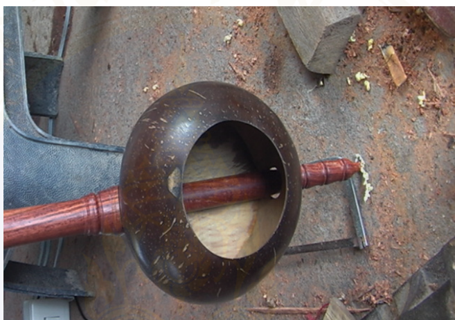
ภาพที่ ๖ – ๑๔ การเจาะช่องกลองเสียงสะล้อ
