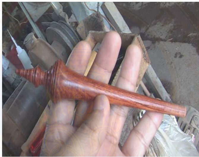
ภาพที่ ๖ – ๘ ลูกบิดสะล้อทำจากไม้ชิงชัน เมื่อกลึงสำเร็จแล้ววัดได้ขนาดความยาว ๑๓ เซนติเมตร บันทึกภาพโดย : กิจชัย ส่องเนตร พุทธศักราช ๒๕๔๕
