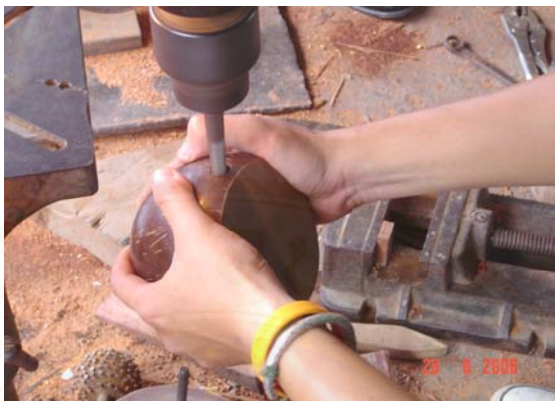
ภาพที่ ๖ – ๑๒ ขั้นตอนการเจาะรูกะโหลกมะพร้าวสำหรับใส่ค้ำมคันทวนสะล้อ บันทึกภาพโดย : กิจชัย ส่องเนตร ปีพุทธศักราช ๒๕๕๕
