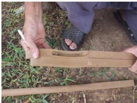
ภาพที่ ๖ – ๓๓ การเจาะร่องไม้สำหรับใส่สายและใส่ลูกบิดเสลื่อเกือบ ช่างกำลังนำคันทวน ต้นแบบมาเทียบสัดส่วนแล้วทำเครื่องหมายเตรียมเจาะคันทวนสำหรับใส่ลูกบิดอันต่อไป
